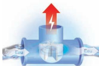
Avec la force de l'eau, la mini turbine intégrée produit instantanément l'électricité nécessaire à l'allumage du brûleur.
